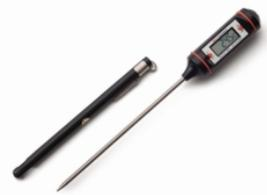
LLG-Цифровой карманный термометр, тип 12050
